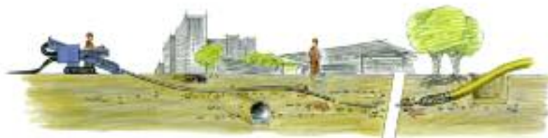
Zanja con colocación simultánea de conductos eléctricos
