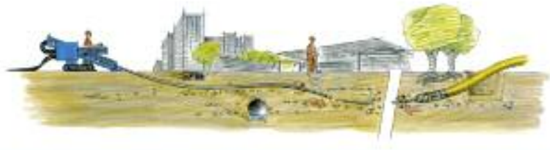
Zanja con colocación simultánea de conductos eléctricos
