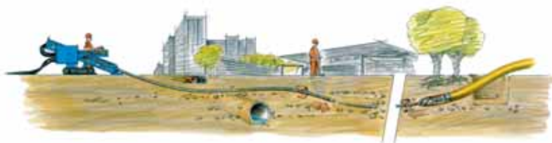
Zanja con colocación simultánea de conductos eléctricos
